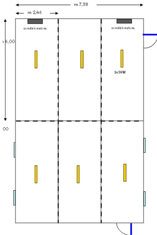
**Nr 01 struttura assemblata in loco formato dall'accoppiamento di 6 box di dimensioni esterne mt 6.00 x 2.46 x 2.70 h**
