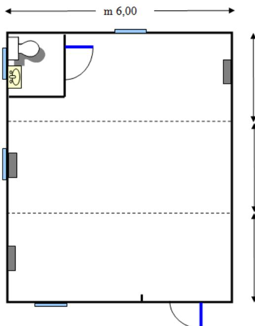
**Nr 01 struttura assemblata in loco formato dall'accoppiamento di 3 box di dimensioni esterne mt 6.00 x 2.46 x 2.70 h**
