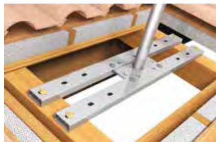
Dettaglio: particolare del fissaggio dei profili
