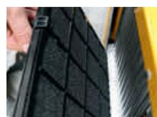
Il filtro dell'aria in schiuma compatta permette di lavorare in spazi molto polverosi
