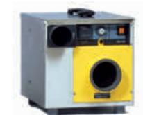
Deumidificatori senza compressore e fluido refrigerante. Hanno una raccolta acqua costante anche a basse temperature. Per temperature inferiori a 5 gradi sono più efficienti dei modelli a condensazione.
