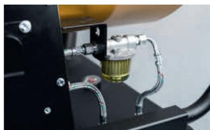
Il filtro gasolio è esterno. La testa di combustione è dotata di preriscaldamento del gasolio.
