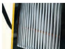
L'ampio spazio tra i tubi di evaporazione evita ostruzioni
