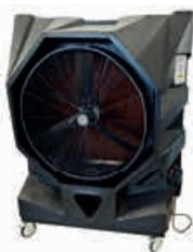
I raffrescatori Master raffrescano l'aria utilizzando un semplice processo naturale: l'evaporazione dell'acqua diminuisce la temperatura dell'aria. Una pompa prende l'acqua da un serbatoio che umidifica un grande filtro in cellulosa naturale. Un potente ventilatore aspira l'aria attraverso il filtro. L'acqua evapora dal filtro e diminuisce la temperatura dell'aria di diversi gradi. L'aria esce pulita e fresca nell'ambiente.
