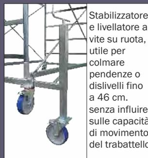
Stabilizzatore e livellatore a vite su ruota, utile per colmare pendenze o dislivelli fino a 46 cm. senza influire sulle capacità di movimento del trabattello
