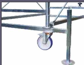
Stabilizzatori/livellatori a vite in acciaio zincato con piattello per base rigida sono utili per compensare pendenze o dislivelli fino a 35 cm. con la massima precisione
