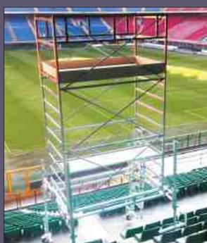
Base GIGANTE con grande capacità di regolazione. Realizzata in acciaio zincato tralicciata, regolabile in larghezza e provvista di n° 4 grandi livellatori regolabili in altezza capaci di compensare dislivelli fino a mt. 1,5. e di n° 4 stabilizzatori a vite. Ideata per un utilizzo su gradinate stadi o su poltrone cinema multisala.
