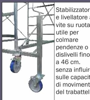
Stabilizzatore e livellatore a vite su ruota, utile per colmare pendenze o dislivelli fino a 46 cm. senza influire sulle capacità di movimento del trabattello
