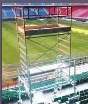
Base GIGANTE con grande capacità di regolazione. Realizzata in acciaio zincato traliciata, regolabile in larghezza e provvista di n° 4 grandi livellatori regolabili in altezza capaci di compensare dislivelli fino a mt. 1,5. e di n° 4 stabilizzatori a vite. Ideata per un utilizzo su gradinate stadi o su poltrone cinema multisala.
