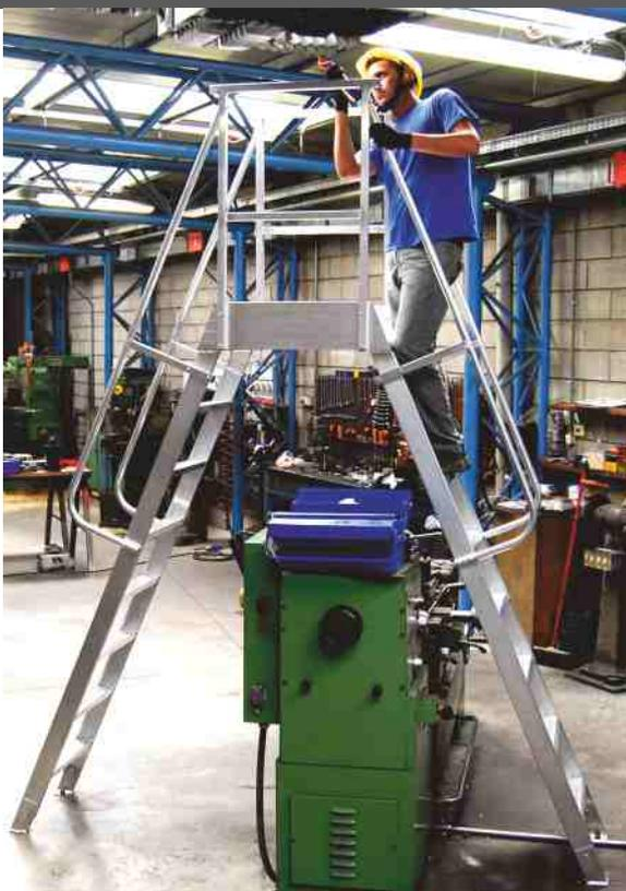
Fornita senza basette stabilizzatrici ma dotata di n° 4 piastre di fissaggio in alluminio anti-ruggine
