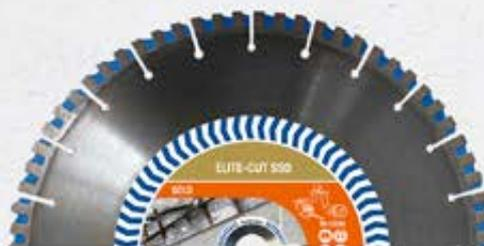
**SPEED BRIDGE** I dischi Elite-Cut sono dotati di un profilo Speed Bridge progettato specificamente. Il design migliora ulteriormente la velocità e la fluidità del taglio grazie a una ridotta frizione laterale, un miglior raffreddamento e una dispersione della polvere ottimizzata. Il colore tra i segmenti indica il tipo di materiale per il quale il disco è ottimizzato.
