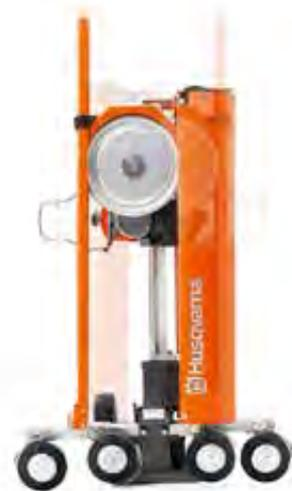
Con CS 10 è possibile praticare tagli sia in verticale sia in orizzontale. La testa di taglio può essere montata orientata verso entrambi i lati del binario e consente di selezionare la direzione di rotazione del filo. Tutto questo offre un taglio a filo altamente flessibile ed efficiente.
