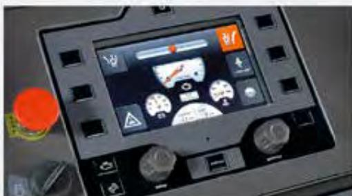
**TAGLI DIRITTI** Sulla FS 5000 D e la FS 7000 D, il pannello di controllo di facile utilizzo comprende un monitor digitale che permette di correggere la traiettoria del taglio. Questo facilita l'esecuzione di tagli dritti, consentendo un'elevata produttività senza sforzi eccessivi per l'operatore.
