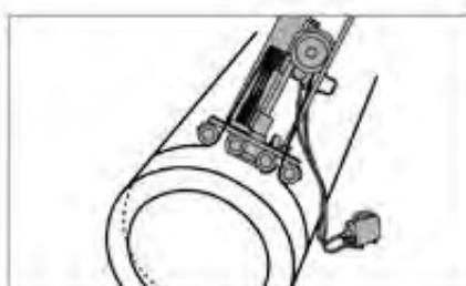
CS 10 è una macchina flessibile e può essere montata facilmente anche nel taglio di tubazioni.
