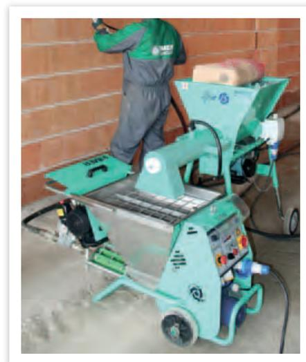
Motoriduttore IMER brevettato ad assi paralleli ad alta efficienza che migliora la trasmissione del moto. La configurazione con motore sotto la vasca riduce gli ombreggi e non necessita di manutenzione e registrazione.
