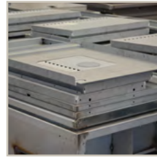
Lamiera zincata utilizzata per aumentare la resistenza e la durata
