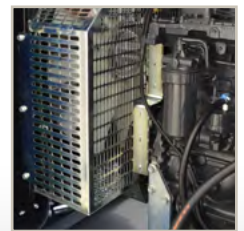
Protezioni parti calde e rotanti per evitare lesioni all'utente
