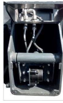
Rilevamento automatico della configurazione degli stabilizzatori attraverso potenziometri posizionati all'interno delle travi per garantirne la protezione.
