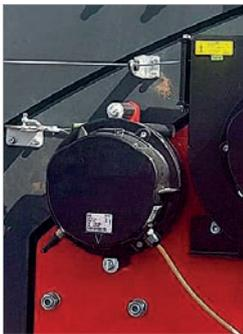
Potenzimetro per il rilevamento dell'angolo e della lunghezza del braccio con sicurezza ridondante.
