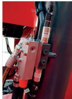
Rilevamento peso del carico tramite 4 trasduttori di pressione: 2 posizionati sul cilindro di sollevamento e 2 sul cilindro di compensazione. Il sistema è dotato di valvole di blocco per aumentare la sicurezza del mezzo in ambiente lavorativo.
