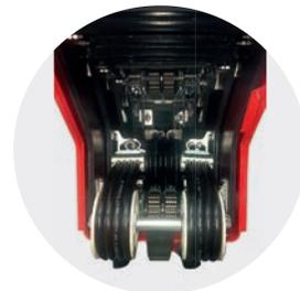
Il blocco, costituito da tubi termo-saldati, previene lo sfregamento tra le singole linee e ne mantiene l'allineamento, contribuendo anch'esso ad una drastica riduzione dei guasti. Le slitte di scorrimento sono fissate su blocchi di acciaio, assicurando il movimento fluido della struttura.
