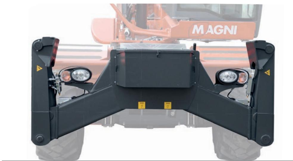
Si tutti i modelli più piccoli la dimensione compatta del telaio è accentuata dagli stabilizzatori pivotanti che sono realizzati sullo stesso asse; quando gli stabilizzatori sono chiusi restano perfettamente in sagoma rispetto alla macchina e non influiscono sulla luce libera dal suolo. Quando gli stabilizzatori sono aperti garantiscono invece un'area di stabilizzazione
