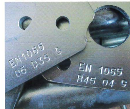
ESEMPIO MARCATURA PIASTRE SECONDO LA NORMATIVA EN 1065 Marked plates (EN 1065 standard reference)
